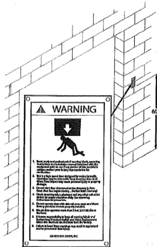
图 11: 警告标签的安装 - 墙壁安装。
